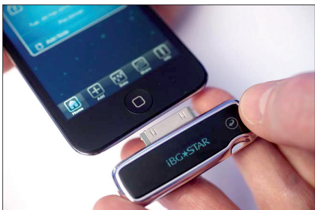
RYCINA 4. Urządzenie do monitorowania stężenia glukozy we krwi iBGStar.
