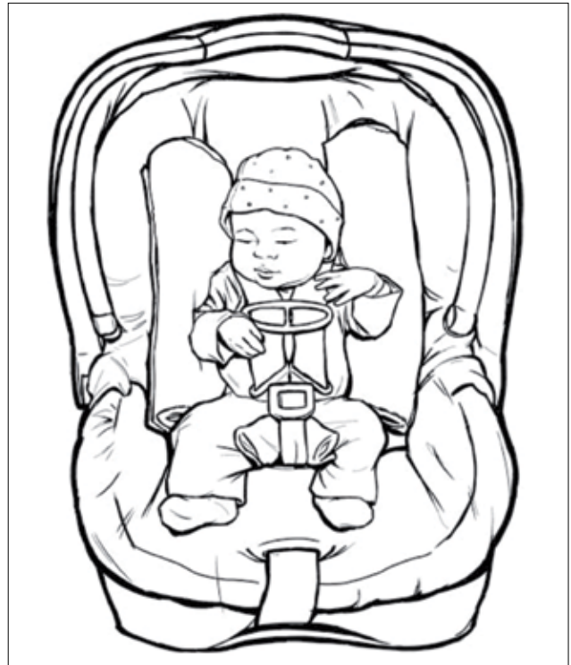
RYCINA 1. Fotelik samochodowy z małym zrolowanym ręcznikiem umieszczonym między pasem bezpieczeństwa przechodzącym przez kroczki a ciałem dziecka pozwala na zachowanie położenia kłamy zapinającej na środku klatki piersiowej, po obu stronach dziecka umieszczono zrolowane kocyki.
