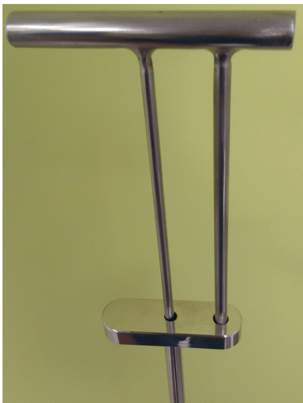
Ryc. 3. Urządzenie blokujące zgłębnika – pręt blokady w ślepym otworze rękojeści osłony zgłębnika (pozycja zablokowana).
