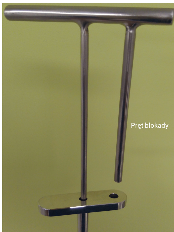
Ryc. 4. Urządzenie blokujące zgłębnika – pozycja odblokowana.
